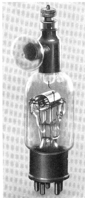
115er Röhre. Die Glasträger für die Gitterteile sind verlängert zur Erhöhung des Kriechweges. Anoden- und Raumladenspannung = 7 V.
