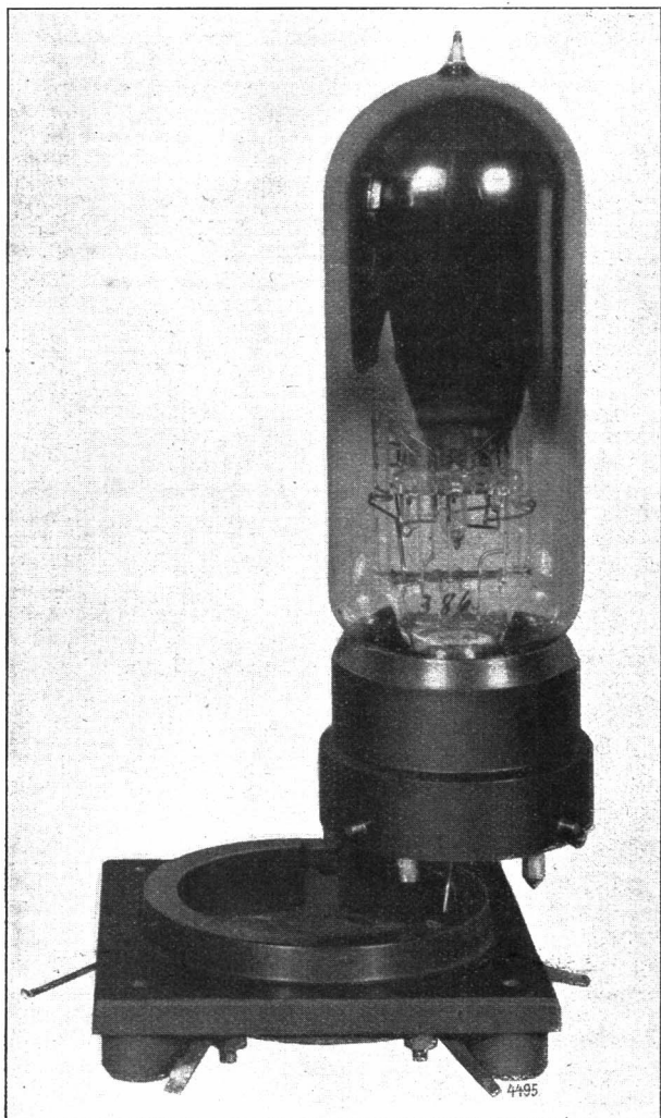
Abb. 5. Hochfrequenz-Mehrfachröhre mit Fassung.
