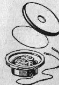
stärker und schwächer, er zieht das Blech mehr oder weniger an. Wird der Hörer dabei ans Ohr gehalten, so vernimmt man bei jedem Ein- und Ausschalten des Stromes ein deutliches Knacken. Beim Wiederaussetzen der Hörers ist darauf zu achten, daß der Deckel nicht zu sehr festgeschraubt wird; die Membran muß schwirren können.
