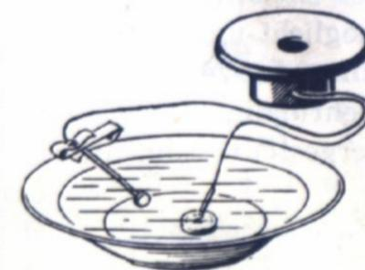
Sicherlich ist der Strom, der aus dem behelfsmäßig zusammengestellten Stromerzeuger (Kupfer-Kochsalz-Eisen) herauskommt, sehr schwach, wohl tausend Mal schwächer als er für ein Lämpchen erforderlich wäre. Der Hörer aber ist anscheinend imstande, noch äußerst schwache Ströme zu erkennen.
