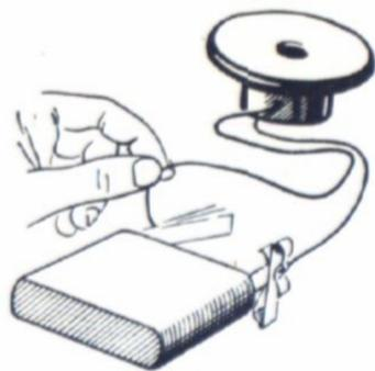
Es soll jetzt einmal ein Ton erzeugt werden. Wir zupfen an der langen Batteriefeder, so daß sie schwirrt. Der dabei entstehende Ton kann nicht gerade schön genannt werden. Nun leiten wir den Strom der Batterie durch den Hörer, indem wir den einen Draht des Hörers am kurzen Streifen der Batterie anschließen und den anderen ganz lose an die schwingende Feder halten. Das Summen der Feder überträgt sich auf den Telefonhörer als Ton.
