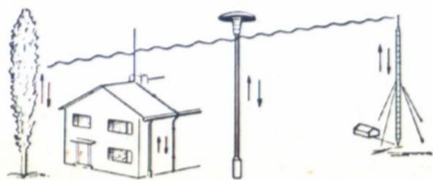
beim nächsten Funken wieder eine Anzahl Schwingungen ausführen müssen. Würde man den Antennendraht 75 Meter lang wählen, ihn an einem Turm aufhängen und den Erd Draht auch 75 Meter lang machen, so hätten die Elektronenstöße bei
