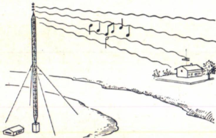
Weil die Schallwellen selbst nicht so weit reichen, lassen sie sich im Rundfunksender von den elektrischen Wellen „auf den Rücken nehmen“ und bis zu unserem Rundfunkempfänger tragen. Dazu wird die Stärke der elektrischen Wellen (Höhe der Wellenberge), die vom Sender ausgehen, im Takte der Schallwellen verändert. In
