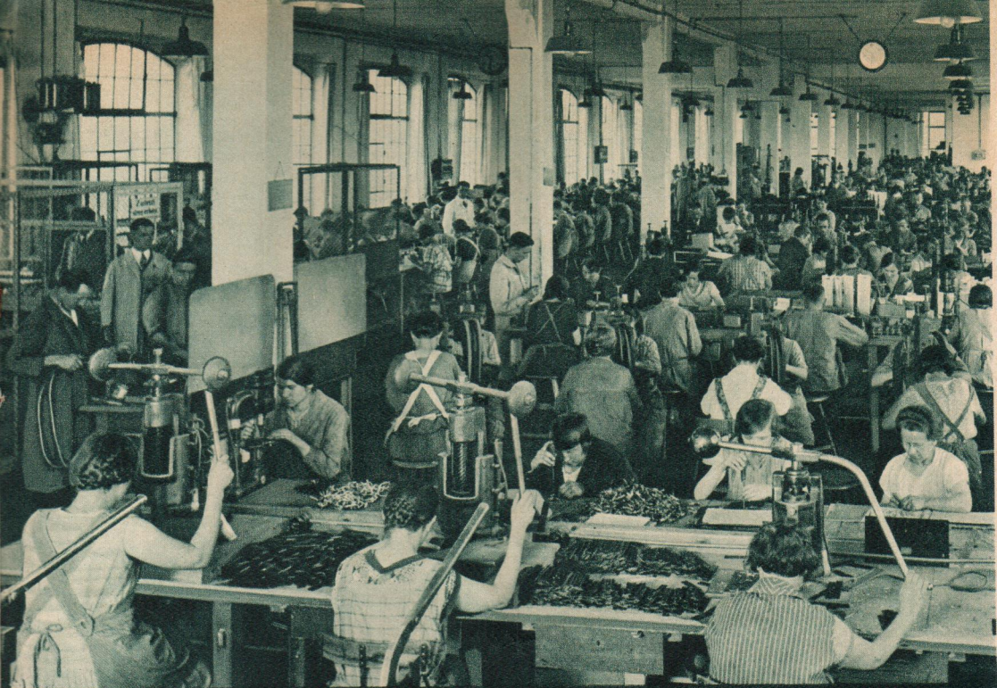
(Unten) Bild 11: Montage von Empfängern und Lautsprechern
