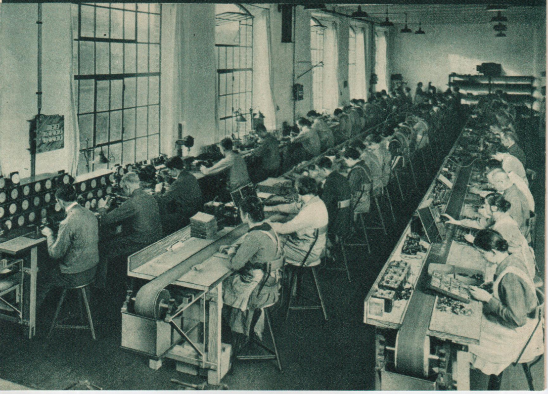
(Unten) Bild 7: Montage von Block- u. Drehkondensatoren
