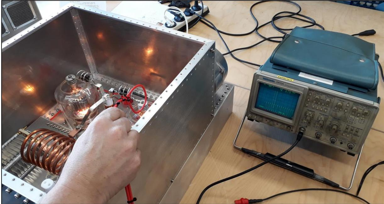
*Beobachtung der parasitären Schwingung mit Leiterschleife aus Teflon-Hochspannungskabel und Oszilloskop*
