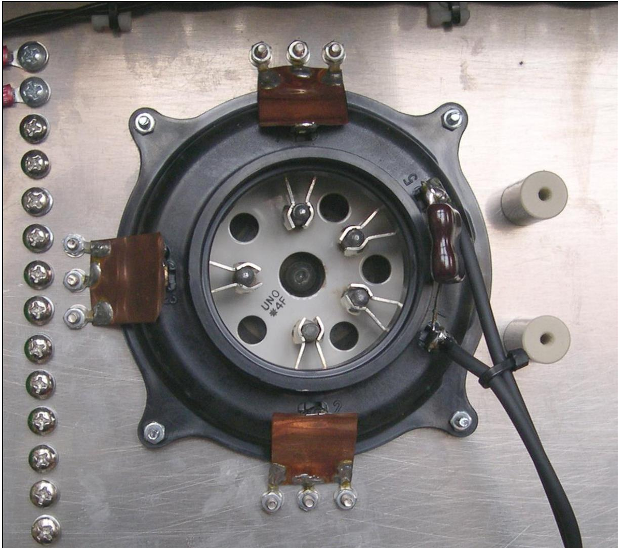
*Die Masseverbindung der Gitter g1 und g2 und die Anbindung des Kathodenkreises*
