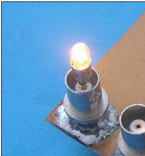
Detailansicht der einseitig kontaktierten Glühlampe ( Nennspannung 14V,37mA, Farnell-Nummer 328-170)
