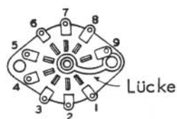
Numerierung der Lötflächen an 9-poligen Röhrenfassungen
