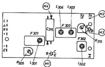
**Bild 3:** Lage der Abgleichelemente, Anschlußlötlösen und Meßpunkte
