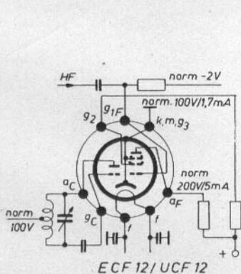
Bild 106. Sockelschaltung mit normalen Betriebswerten für ECF 12/UCF 12
