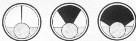
Bild 192. Schirmbild des Magischen Fächers. Links bei Anzeige des Ortssenders, in der Mitte bei Anzeige eines mittelstarken Senders, rechts kein Sender
