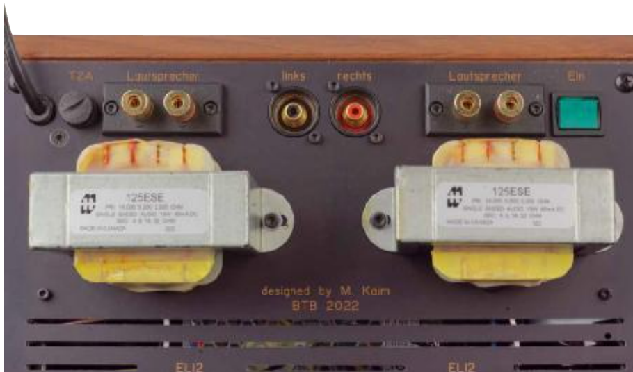
Die Anschlüsse sind alle mit in die Deckelplatte integriert, das erleichtert den Aufbau
